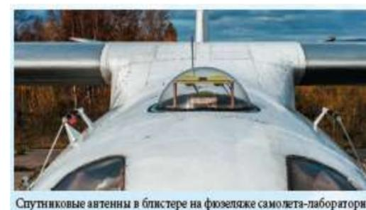
Спутниковые антенны в блистере на фюзеляже самолета-лаборатории
